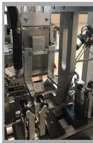
Mentre l'astuccio viene portato verso l'alto sul nastro di uscita, viene piegato, incollato e chiuso totalmente.
