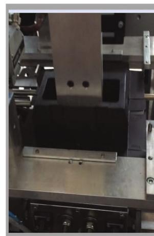
L'astuccio, una volta prelevato dal magazzino laterale, viene modellato e piegato durante il suo spostamento verso il nastro di trasporto principale.
