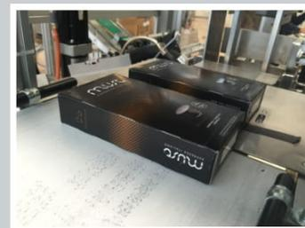
AVF36 è una macchina elettronica a moto intermittente per l'impacchettamento di capsule termoformate o astucci, confezioni termosaldate "flow-wrap", buste o altri prodotti aventi forme differenti e altro ancora.
